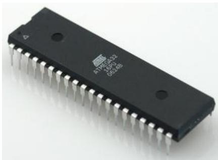
Gambar 1. Mikrokontroler ATmega32
